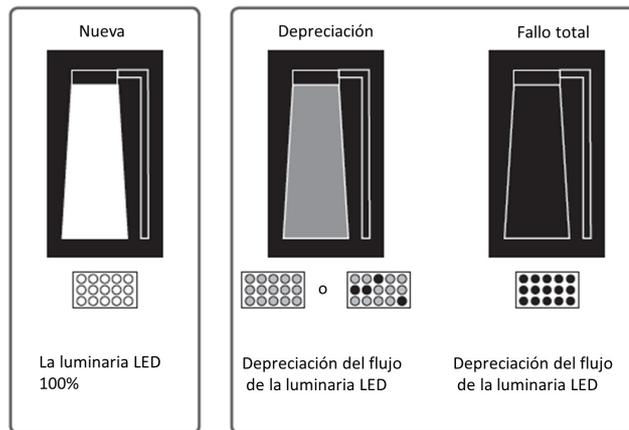
La vida útil estimada de este modo no tiene en cuenta el posible fallo total de luminaria, sino a la depreciación de flujo de las luminarias de LED en una determinada instalación. Se considera que en caso de fallo total de luminaria, ésta debe ser sustituida de modo relativamente inmediato con lo que no restaría nivel de iluminación.
